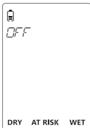
Al presionar ►, se cambia del estado apagado al encendido y viceversa.
