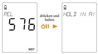
Es erscheint ein Lauftext mit dem Hinweis "Halten Sie das Gerät in der Luft und drücken Sie rechts". Halten Sie das Gerät in die Luft von anderen Gegenständen weg und drücken Sie dann die Taste, um das Gerät im REL-Modus zu kalibrieren.
