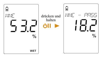
Drücken Sie die Taste , um die Prüfung der Kalibrierung zu beenden.
